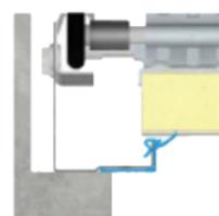
Joints double lèvres plus large permettant une réduction des écoinçons et de la retombée de linteau nécessaire
